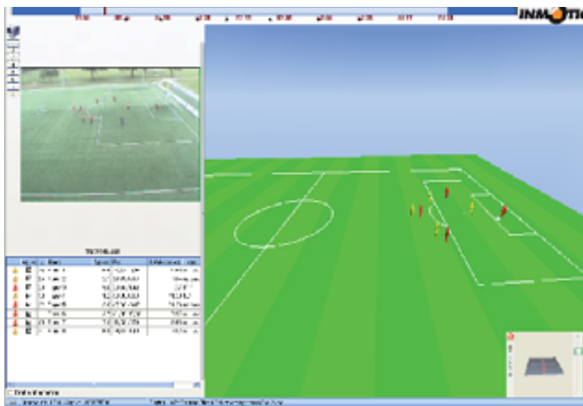
LPM Soccer peilt iedere speler duizend keer per seconde met een precisie van vijf centimeter.
